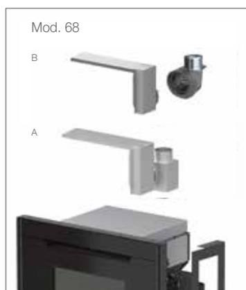
Synthesis Modular è fornito di serie con l'uscita dell'aria calda frontale e relativa regolazione in uscita. È possibile canalizzare 1 o 2 bocchette (2 bocchette per mod 80) d'aria calda in altri locali senza ventilatore aggiuntivo (A). È prevista l'aggiunta di un ventilatore addizionale destro da 170 m<sup>3</sup>/h per una maggiore distanza (B).
